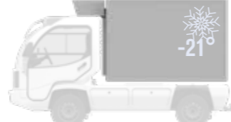
TK - Isolierter Tiefkühl-Kofferaufbau
