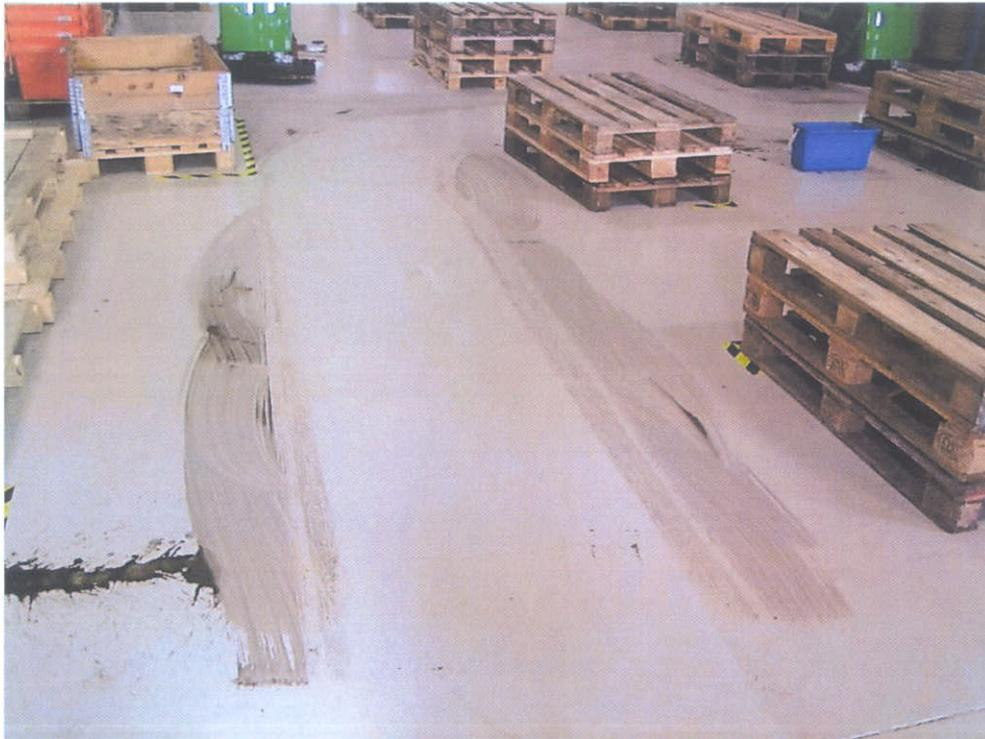
Reinigung gerade Strecke mit der Maschine ohne GWS
